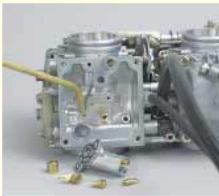
**9. Mit Druckluft die Bohrungen freipusten**
