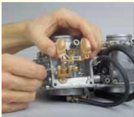
**6. Achse herausziehen und Schwimmer entfernen**
