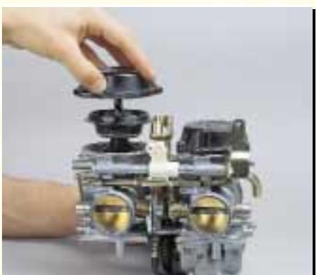
**7. Unterdruckkolben ausbauen und prüfen**
