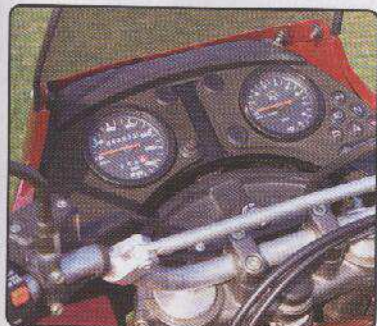
Geländelenker mit Querstrebe, großes Cockpit mit weit auseinander liegenden Rundinstrumenten
