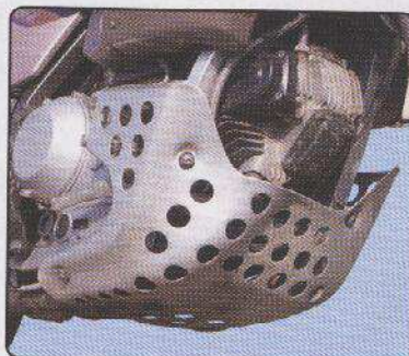
Umfassender Leichtmetall-Schutz für den V-Zweizylinder, die Rahmen-Unterzüge sind abnehmbar
