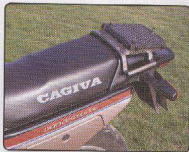
Für eine heutige Reiseenduro schmale Sitzbank, Gepäckträger aus Leichtmetall-Guss, hier mit einem aufgeschraubten Topcase-Unterteil
