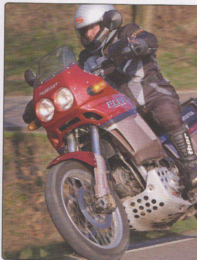
Für eine heutige Reiseenduro schmale Sitzbank, Gepäckträger aus Leichtmetall-Guss, hier mit einem aufgeschraubten Topcase-Unterteil
