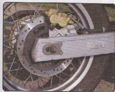
Solide Hinterradschwinge mit groß dimensionierten Holmen aus Leichtmetall-Rechteckrohr
